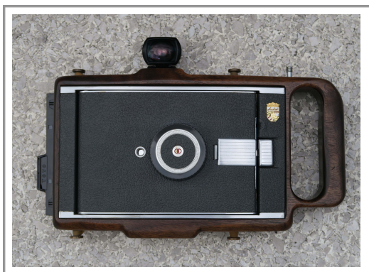
加工した本体を木枠に固定した状態
