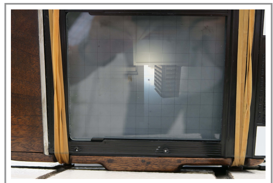
フィルムホルダーに嵌めたピントグラスに像が映る様子
