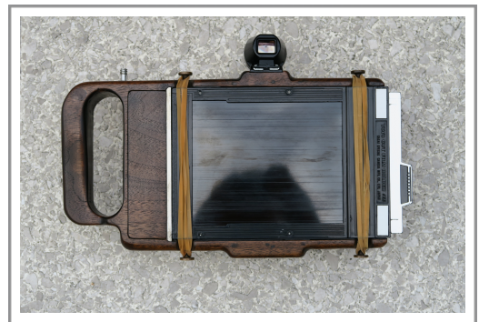
4x5フィルムホルダーを取り付けた様子
